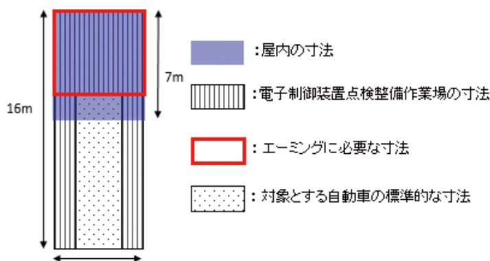
電子制御装置点検整備作業場のイメージ
